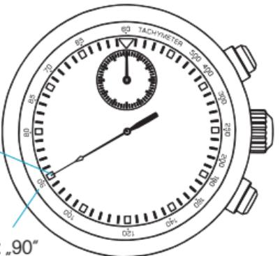
$$\begin{aligned} "90" \text{ (údaj z tachymetrické stupnice)} \times 1 \text{ (km nebo míle)} \\ = 90 \text{ km/h nebo mph} \end{aligned}$$
