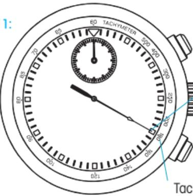
$$\begin{aligned} "180" \text{ (údaj z tachymetrické stupnice)} \times 1 \text{ úkon} \\ = 180 \text{ úkonů za hodinu} \end{aligned}$$
