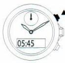
**Zapnutí** - Ujistěte se, že jste v režimu nastavení budíku. Tlačítkem A aktivujete budík. Zvukový signál potvrdí aktivaci. Na displeji se zobrazí čas buzení.
