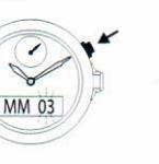
Stiskněte tlačítko B. Bliká datum. Tlačítkem A nastavte datum. Stlačte tlačidlo B. Bliká datum. Tlačidlo A nastavte datum.
