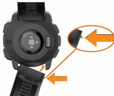
**POZNÁMKA:** Zkontrolujte, zda je řemínek rádně připevněn. Osička musí zacvaknout do příslušných otvorů na zařízení.
