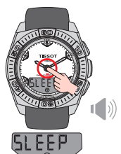
Automatické přepnutí na pohotovostní režim po 10 sekundách. Pipnutí každou sekundu
